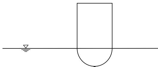
**Exercice 4** Le dôme posé au fond du Golfe du Mexique pour colmater la fuite d'hydrocarbure peut être représenté par un hémisphère de rayon  $a$  qui repose à une profondeur  $h$  dans un fluide de masse volumique  $\rho$ .
